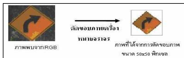
รูปที่ 7 ภาพที่ตัดขอบภาพโดยย่อขนาด 50x50 พิกเซล
